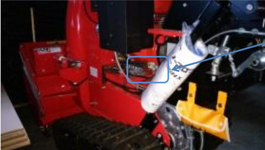
本体左後ろ側から見える場所のエンジンブロック最下部に、シリアルナンバーが刻印されています。
